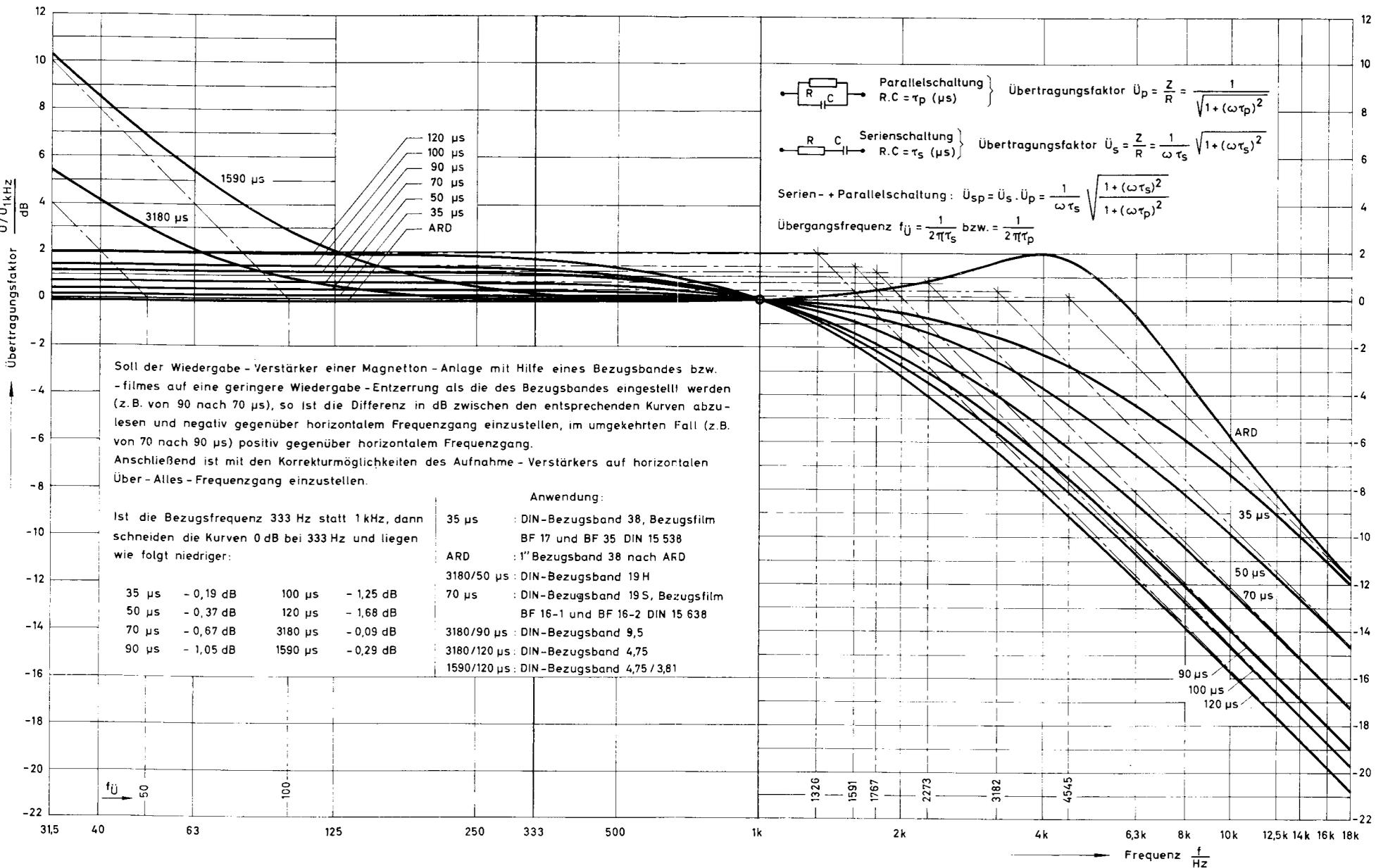
Abb. 16. Darstellung der Verläufe der verschiedenen Übertragungsfaktoren in Abhängigkeit von der Frequenz, die bei den DIN-Bezugsbändern und DIN-Bezugsfilmen Anwendung finden.
